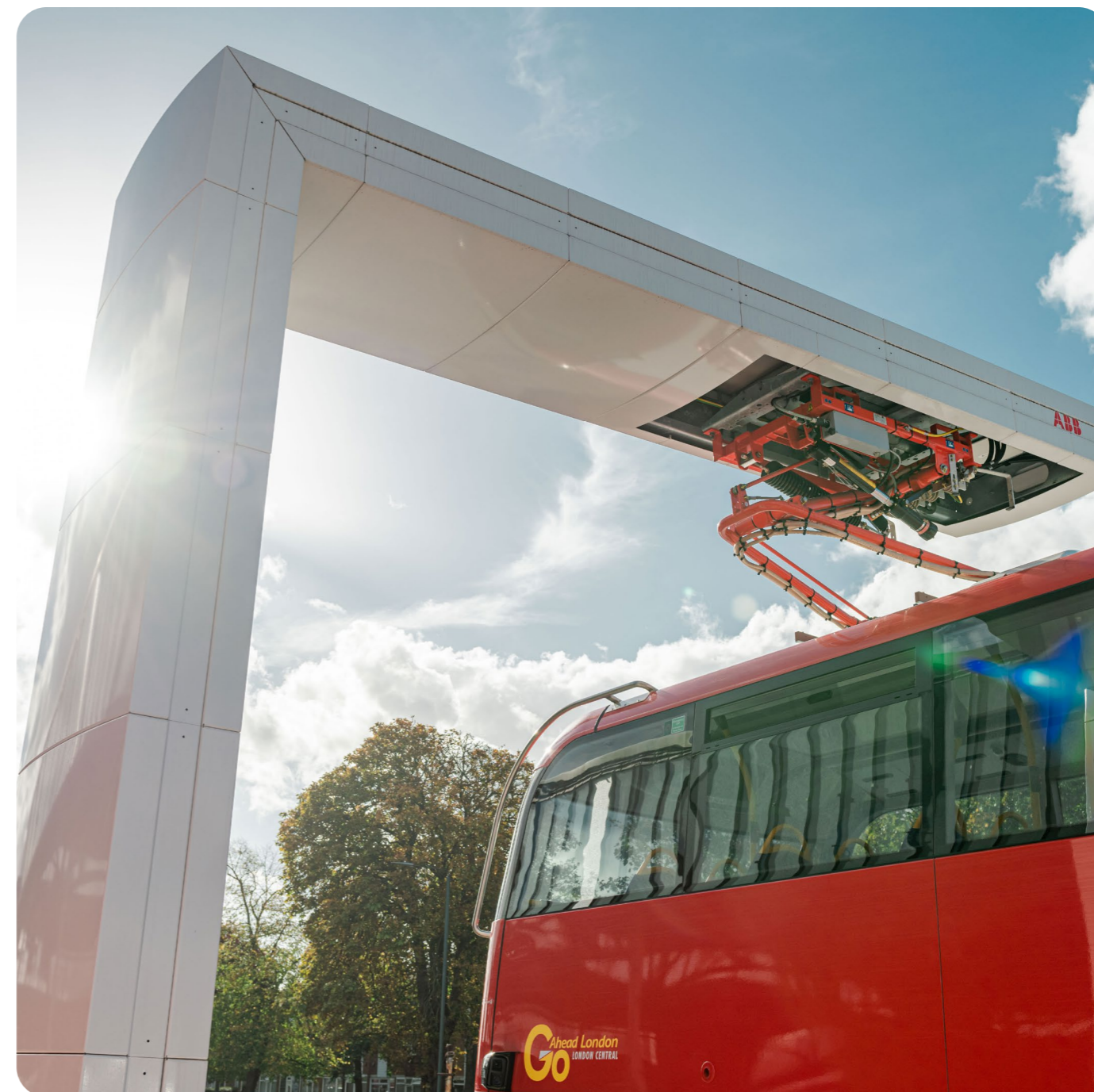
Pantografová nabíjacia stanica – typ „Top-down“ (Zdroj: ABB)
