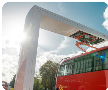
Pantografová nabíjacia stanica integrovaná v prestrešení zastávky v meste Freiburg (Zdroj: Freiburger Verkehrs)
