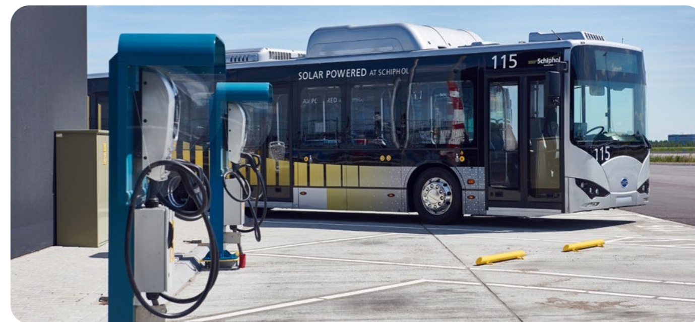
Cestný spomaľovací prah pre uľahčenie pristavenia vozidla (Zdroj: Letisko Schiphol, Amsterdam)
