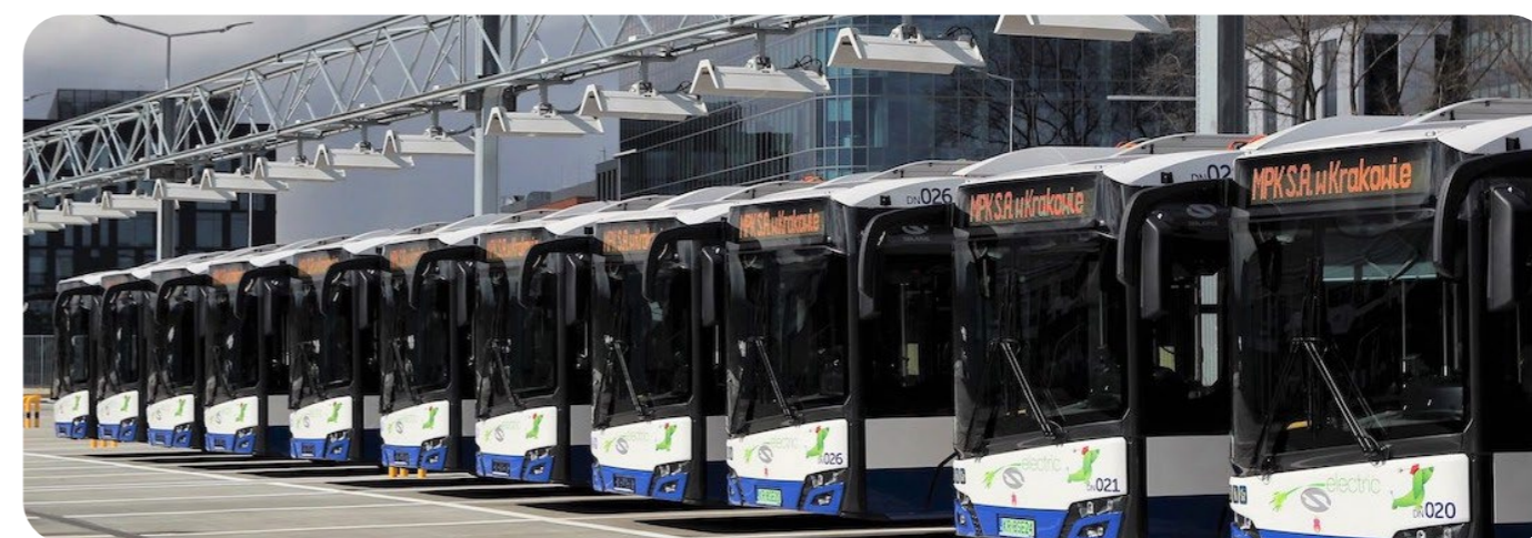
Paralelné parkovanie v depa s pantografovým nabíjaním v meste Krakov (Zdroj: Solaris)
