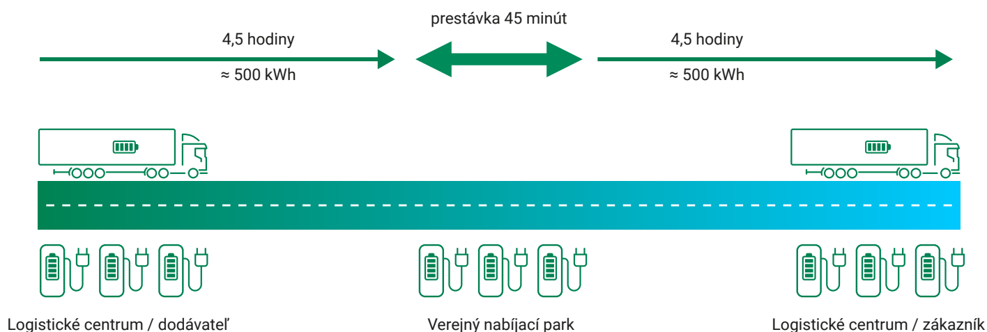
Obrázok 22: Očakávaný cyklus nabíjania pri prepravách na dlhšie vzdialenosti. Zdroj: SEVA
