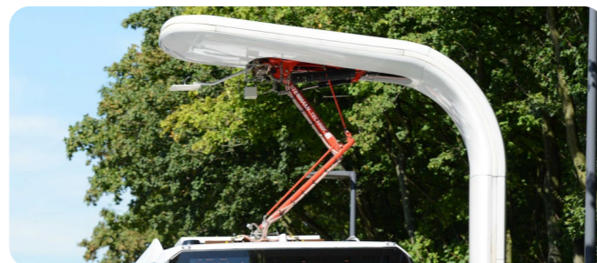
Bottom-up pantografová stanica v meste Münster (Zdroj: Stadtwerke Münster)
