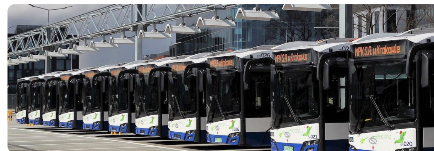
Paralelné parkovanie v depe s pantografovým nabíjaním v meste Krakov (Zdroj: Solaris)
