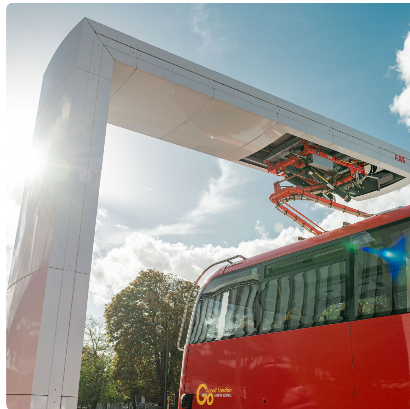
Pantografová nabíjacia stanica – typ „Top-down“ (Zdroj: ABB)
