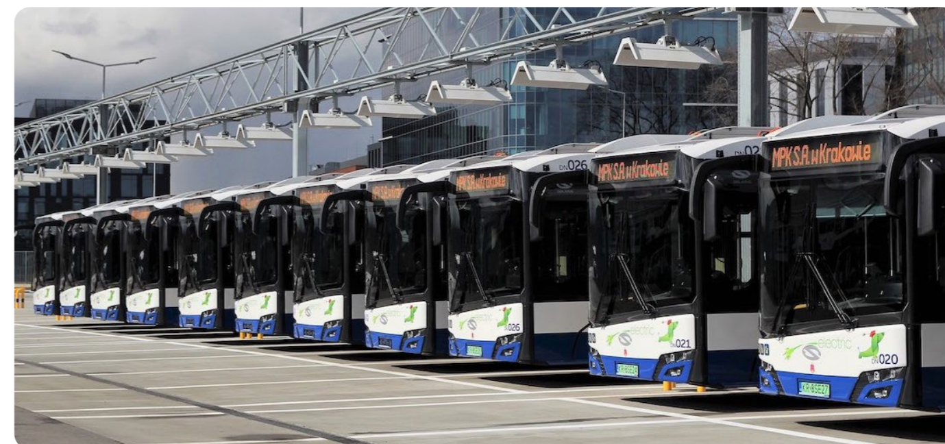
Paralelné parkovanie v depe s pantografovým nabíjaním v meste Krakov (Zdroj: Solaris)
