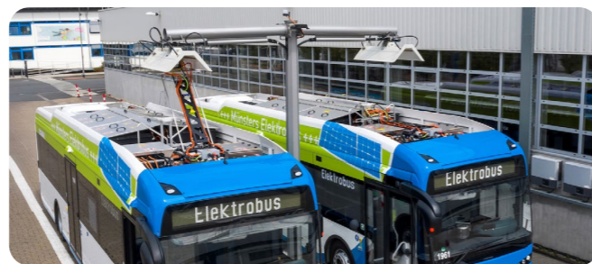
Top-down pantografová nabíjacia stanica v meste Hamburg (Zdroj: Siemens)
